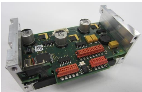
Steuerelektronik im Läufer
