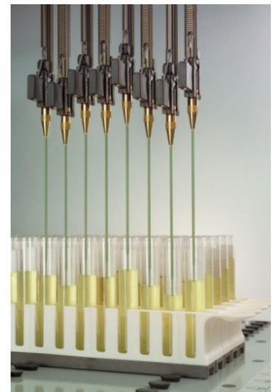
Acht Pipetten berühren unterschiedliche Flüssigkeitslevels
